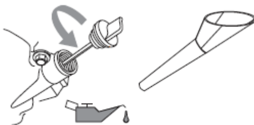
Мал. 11 Отвір для заливки олії з лійкою
